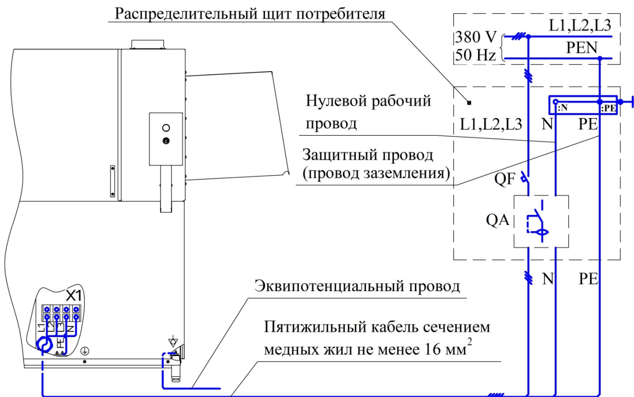
Рисунок 9 - Схема подключения машины к электрической сети
